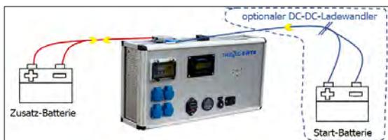
**TRUSTEC E-HYB Anschluss an die vorhandene Fahrzeug-Zusatzbatterie**
